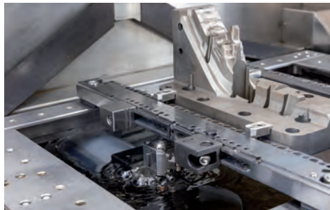
Smart-Grip BAR Vice-Slide mit Spannbacken fest und beweglich
