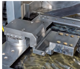
Smart-Grip AIR mit Justierpalette 3D und Schraubstock Smart Vice 0 – 120 mm
