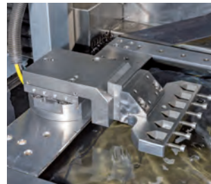
Smart-Grip AIR mit Justierpalette 3D und 6-fach Prisma
