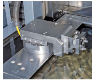
Smart-Grip AIR mit Justierpalette 3D und EROWA Quick Chuck 50
