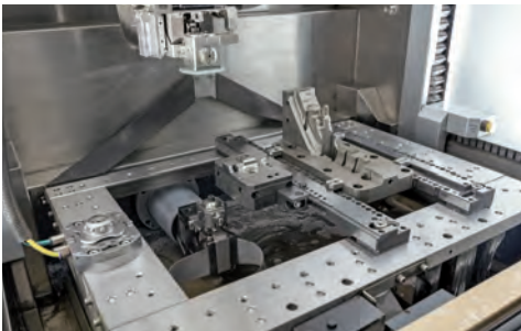
Smart-Grip BAR Vice-Slide und Slide sowie Palettenträger Smart-Grip AIR
